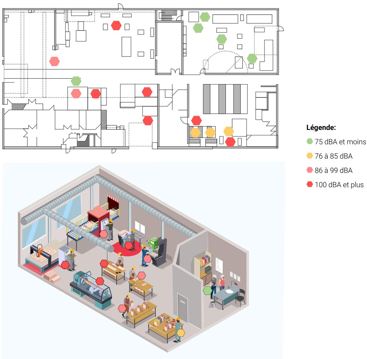
**Figure 11 : Exemples de plans sommaires d'un établissement avec des zones de travail où des informations relatives au bruit sont rapportées**
